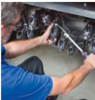
Al cambiar el soporte, el par de apriete del tornillo es de solo 100 Nm.
