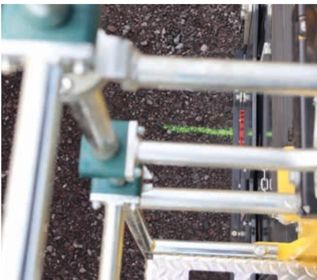
En **las rehabilitaciones** parciales de las carreteras regionales, se retiran de forma selectiva las capas dañadas. Unas marcas bien visibles en las placas laterales facilitan una recolocación precisa.
