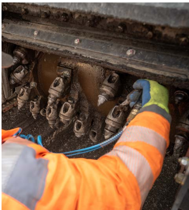
Vereinfachen Sie sich die Arbeit mit unserem pneumatischen Meißelaustreiber | Simplify your work with our pneumatic ejector for cutting tools
