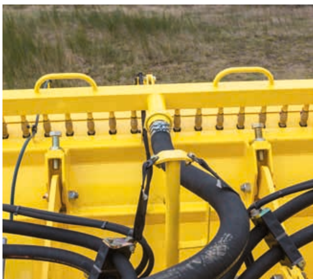
Flexible: 17 toberas de riego que se pueden conectar y desconectar individualmente.
