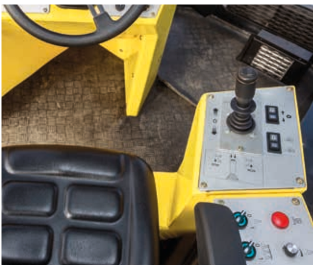
La palanca de marcha y el freno de rueda individual en el eje trasero aportan mayor precisión y capacidad de maniobra.
