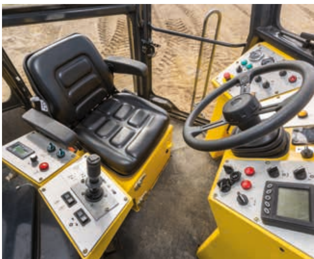
El asiento del conductor está colocado en diagonal, para una postura ergonómica que reduce la carga del conductor.
