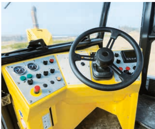
La dirección asistida hidráulica mejora la movilidad en la obra.
