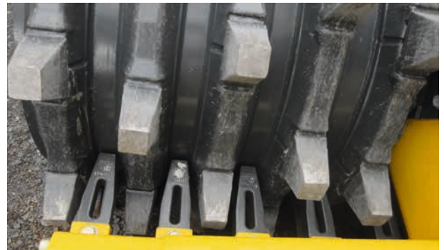
Rascador ajustable para un trabajo sin interrupciones.
