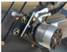
Después de descansar la barredora en el suelo, retire los pasadores de soportes de motor y cojinetes.
