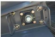
Saque el motor y el ensamble de accionamiento hexagonal. El núcleo / cabezal del cepillo caerá, no necesita remover las mangueras hidráulicas.
