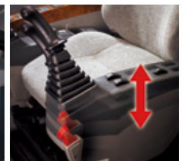
Pedestal de control (función telescópica)
