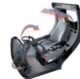
El aire acondicionado de alto rendimiento provee un caudal de aire que se ajusta y controla electrónicamente según las condiciones imperantes. Cinco modos de operación hacen que el operador más exigente pueda verse satisfecho.
