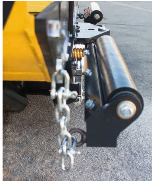
Montaje sin sacudidas – viga de presión amortiguada.
